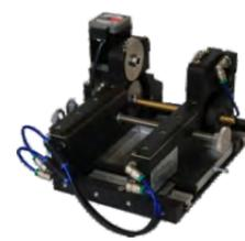
Développé grâce à l'aide de l'industrie de la bijouterie, le système d'avancement automatique pour feuille permet de couper des objets à partir d'une feuille de métal sans avoir à la positionner manuellement. Équipé de soupapes pneumatiques et de commandes électroniques, il est en mesure de positionner la feuille sans la présence d'un opérateur.
